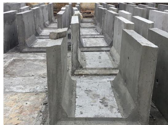
2.8. Dải phân cách, bờ vỉa, các tấm đan được sử dụng bằng bê tông đúc sẵn:
